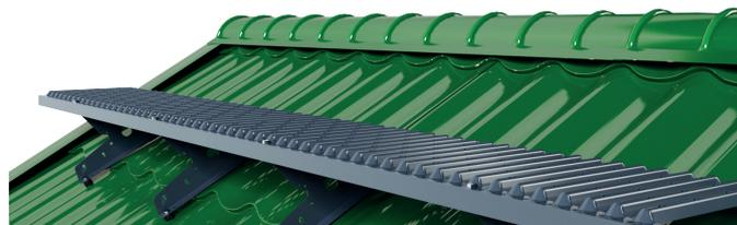
В случае необходимости платформа переходного мостика обрезается с помощью электролобзика или ножовки по металлу до необходимой длины. Допускается использование абразивного режущего инструмента (болгарка).
