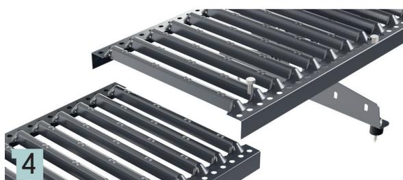
**1.** Монтаж переходного мостика начинается с установки универсального кронштейна в зависимости от типа кровельного покрытия (рис. 1a-1d). Максимальное расстояние между кронштейнами 732 мм. Расстояние от последнего универсального кронштейна до края платформы переходного мостика не должно превышать 250 мм. Для герметизации отверстий используются уплотнители h-7 мм и h-14 мм.
